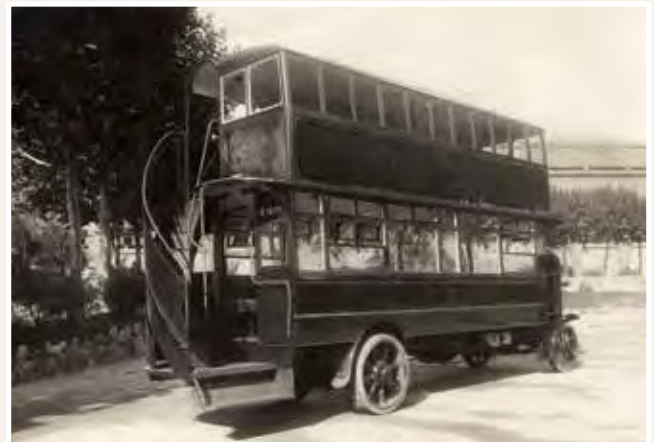
Prototipus d'autobús Tilling-Stevens amb el pis superior cobert. 1927. Autor desconegut .Arxiu Fundació TMB.
